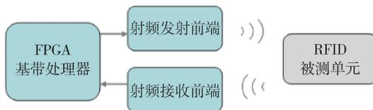
图 4 改进的激励响应模式原理示意图
