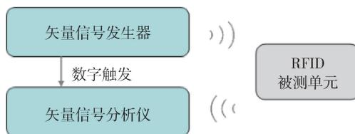
图 3 激励/响应模式原理示意图
