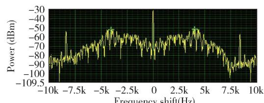
图 11 单个标签的返回频率测试图
