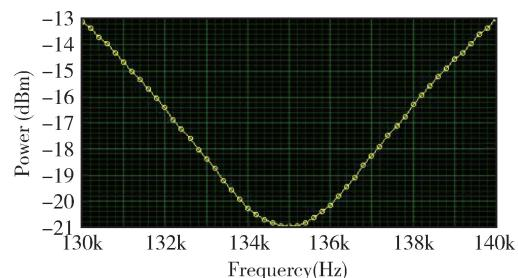
图 10 单个标签的谐振频率测试图
