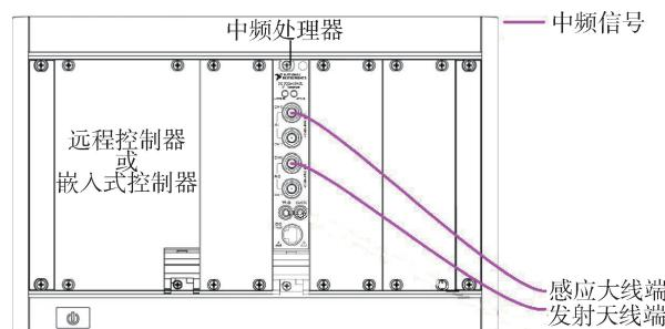
图 9 硬件层与天线装置连接方式示意图
