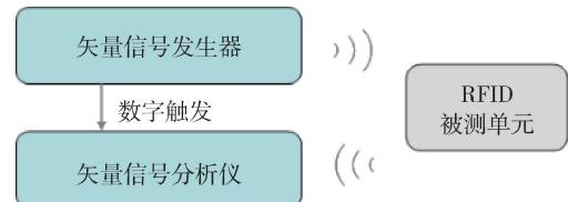
图 3 激励/响应模式原理示意图
