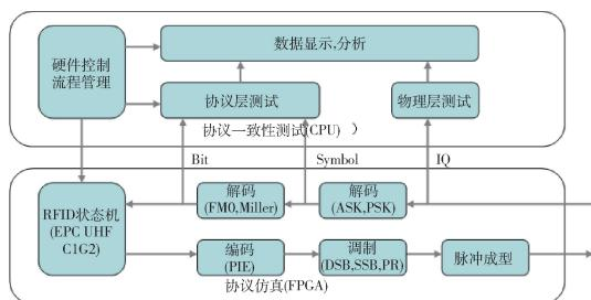
图 6 软件信号传输原理示意图
